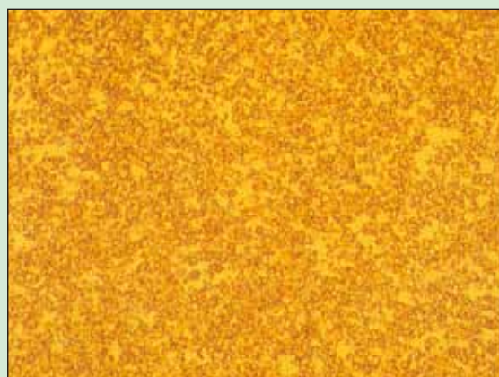
■全く新しいタイプの焼結硬質合金です。その組織は、微粒の複硼化物の硬質相とそれを埋める鉄ベースの結合相からなり、100%の密度をもった微細で均一な複合組織です。
