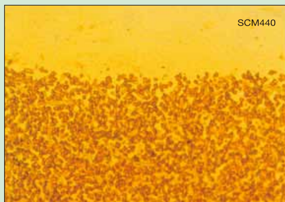
■焼結硬質合金と鋼材との焼結接合界面です。1~3μm粒径の灰色または黒色粒子は鉄基複硼化物、白色は結合材を表わしています。上側は母材SCM440で、接合界面は鉄基複硼化物粒子が10μm程度の幅でまばらに分散した拡散層を形成し良好な接合状態となっています。
