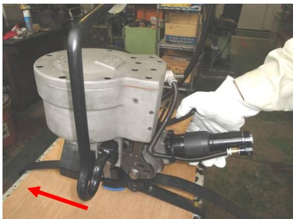
①右手親指で A レバーを押すと、モータ用弁棒が押し上げられ、エアモータが回転を始め、矢印の方向にツールが前進し、ストラップを引締めます。
