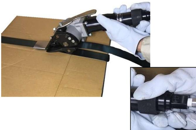
スロットルバルブを反時計回りに回してください。(エアモータ回転によりフィードホイールが回転)
